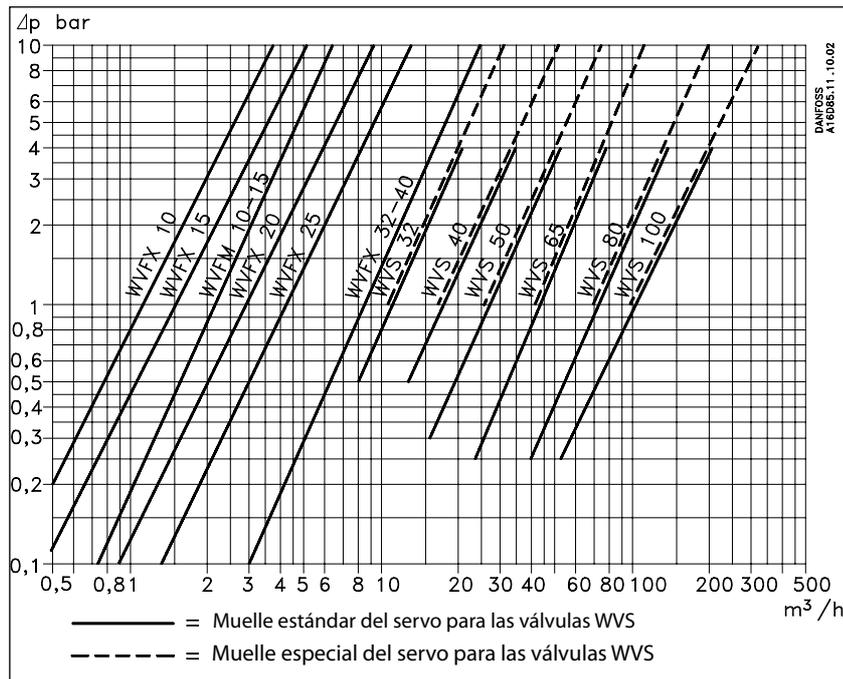
Las curvas de capacidad muestran las capacidades de las diferentes válvulas (cantidad de agua en m<sup>3</sup>/h) en función de la pérdida de carga a través de las mismas.
