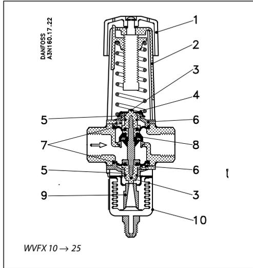
El plato de válvula (8) se compone de un disco de latón sobre el que se ha vulcanizado un caucho especial que forma una junta de estanqueidad elástica contra el asiento de válvula. En el exterior, la estanqueidad de la válvula es asegurada por membranas (7).
