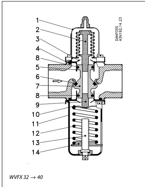
El cono (7) de la válvula es de latón con un anillo en forma de T (6) en caucho sintético que forma una junta elástica contra el asiento de válvula. Las juntas tóricas (8) en caucho sintético impiden las fugas del agua de refrigeración hacia el exterior.
