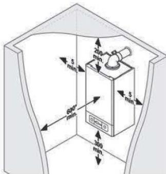
Puede colocarse una puerta de compartimiento extraíble a una distancia mínima de 5mm con respecto a la parte frontal del aparato.
