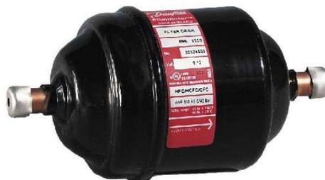
Existen dos tipos de núcleos para el **Eliminator®**. Los filtros secadores del tipo DML tienen un núcleo compuesto por Molecular Sieve al 100%, mientras que el tipo DCL contiene un 80% de Molecular Sieve y un 20% de alúmina activada.
