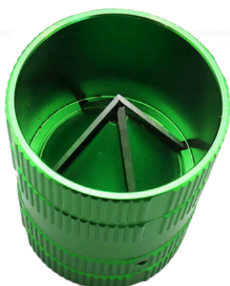
DESBARBADO DE LA TUBERÍA INTERIOR
