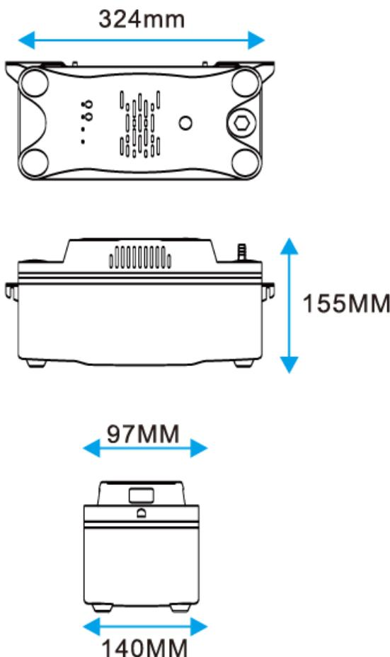
La bomba de condensado TPF-20 esta Equipada con un interruptor activado por flotador para la detección automática de nivel alto de agua (interruptor de detección de desbordamiento).
