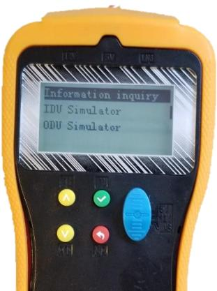
*Simular la unidad interior sirve para determinar si la unidad exterior responde y así verificar que la placa exterior está OK.*
