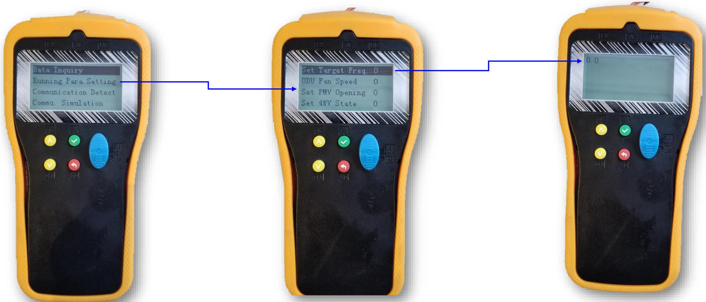
Configurar parámetros manualmente para probar componentes (conexión de 5V)
