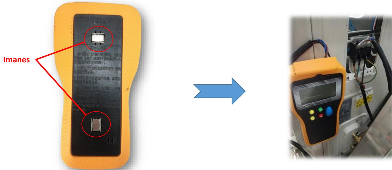
El dispositivo tiene 2 imanes en la parte posterior, lo que permite colocarlo sobre cualquier superficie metálica, como la carcasa de la unidad exterior
