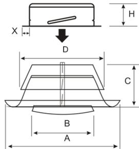
Válvulas de extracción de aire en acero con núcleo ajustable y marco de montaje de 50 mm – EAV:
