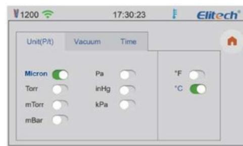
**Vacuum** - Vacío Defina el valor objetivo (target) de vacío, el intervalo y la activación de la grabación de datos.
