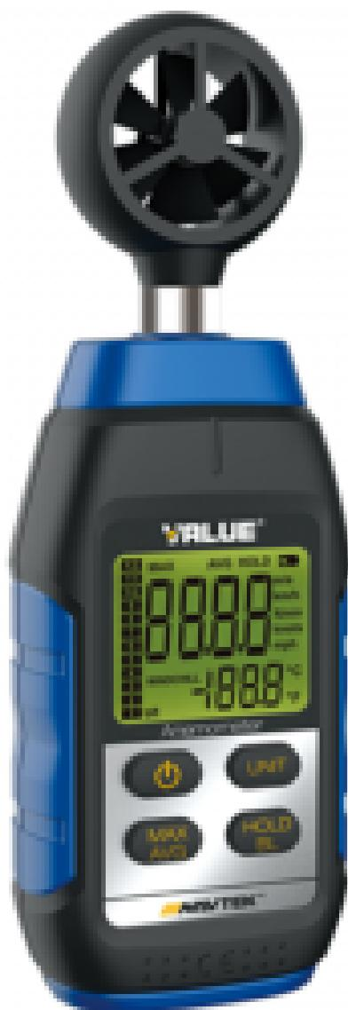
El anemómetro VMA-1, con tecnología de sensor magnético y chip amplificador informático de precisión, permite convertir directamente el caudal de aire en señales eléctricas; a través del chip del microprocesador para procesar datos, utilizando la pantalla digital electrónica para proporcionarle mediciones precisas. Resolvió los problemas del anemómetro tradicional, como el gran volumen y la alta velocidad del aire inicial, garantizando una medición precisa.
