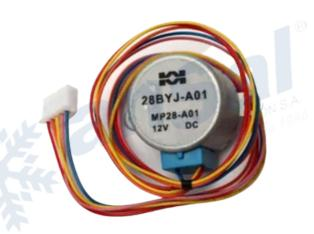
Los terminales (pines) comunes del zocalo del motor de Swing son salidas de 12V. El pin comun del motor paso a paso debera insertarse en uno de los pines comunes del zocalo de la plaqueta. Si la direccion de giro del motor es erronea, coloque el pin comun del motor en el otro pin comun del zocalo, invirtiendo el conector del motor.
