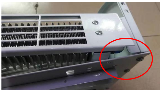
2.3.1. Inserto de alineación de muesca derecha
